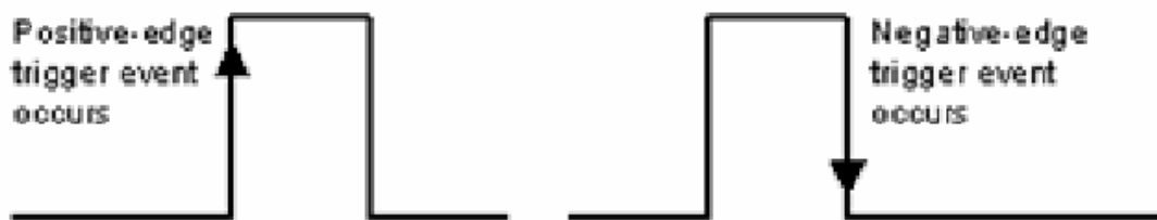
図4-9 : 外部デジタルトリガー入力
